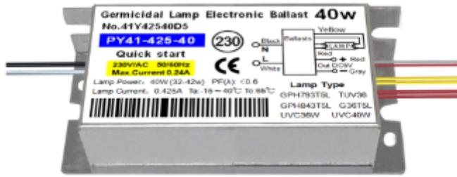
产品特点：快速启动，功率 40W、输出电流 425mA、非恒流，电线输入输出，带 1 只灯。
